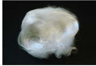
Obr.14. Chomáč připravený odstředivým zvlákněním
