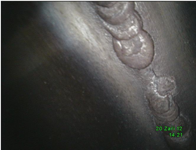
Defekt 2 – Neprovařený kořen v délce 3 mm
