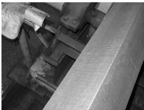
Obr.4 Snímání povrchu sochoru laserovým profiloměrem
