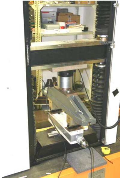
Obr. 1: Ohybové namáhání vzorku Fig. 1: Flexural loading of the sample
