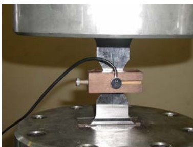
Obr. 7 Zařízení ION-C pro měření ZN a jeho sonda při kalibraci vzorku
