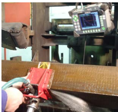
Obr. 4 Zkoušení sochoru imerzní hlavičkou v dynamickém režimu s indikací vady
