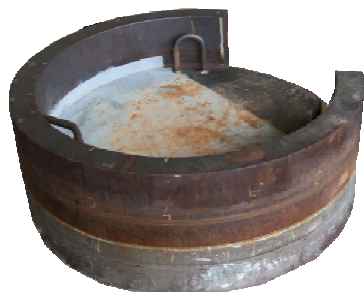
Obr.2 Zkušební těleso svaru kolektoru parogenerátoru (vlevo) a provádění praktické zkoušky (vpravo)
