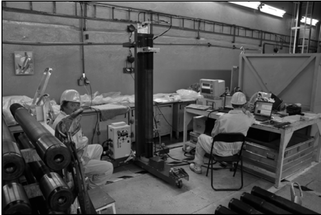
Fig. 1: Manipulator KOMAŠ II (Škoda JS, Czech Republic) Obr. 1: Manipulátor KOMAŠ II (Škoda JS, Česko)
