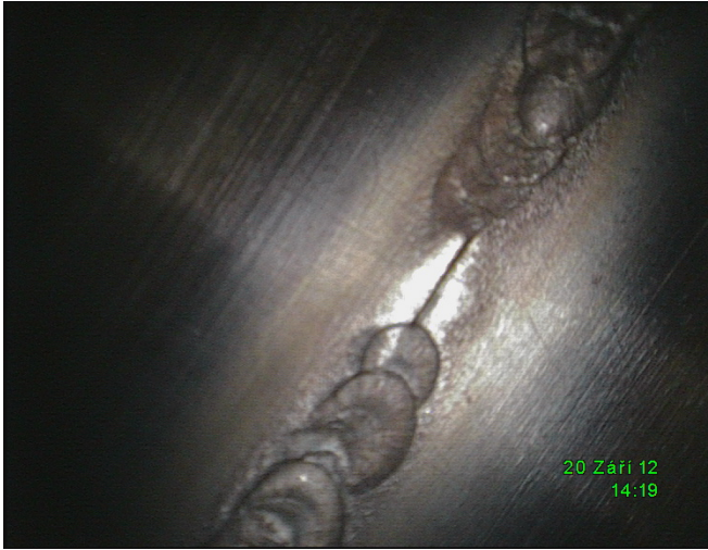
Defekt 2 – Neprovařený kořen v délce 3 mm
