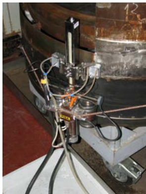
Obr.2 Zkušební těleso svaru kolektoru parogenerátoru (vlevo) a provádění praktické zkoušky (vpravo)
