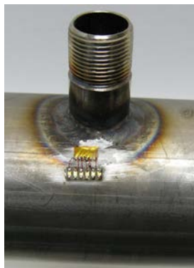
Obr. 5 Příklad aplikace metody odvrtání otvoru
