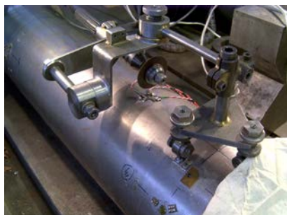
Obr. 6 Zařízení pro měření zbytkového napětí rozřezávací metodou
