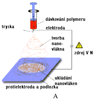
Obr.5 A Základní uspořádání k tvorbě nanovláčna B Modifikace uspořádání
