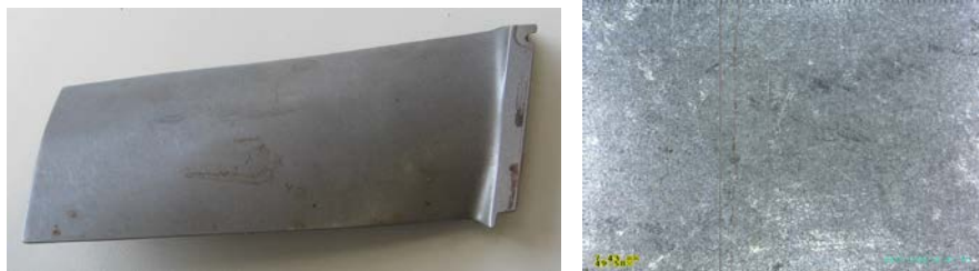
Obr. 9. Testovaná lopatka s defektem: a) celkový záběr, b) detail s defektem (zvětšeno 20x).
