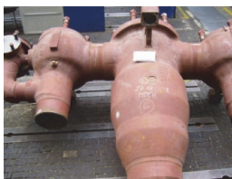
Obr. 10 Kontrola svaru ventilu
