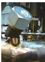
Obr. 17 Kontrola mikrostruktury Cu součásti po zapájení
